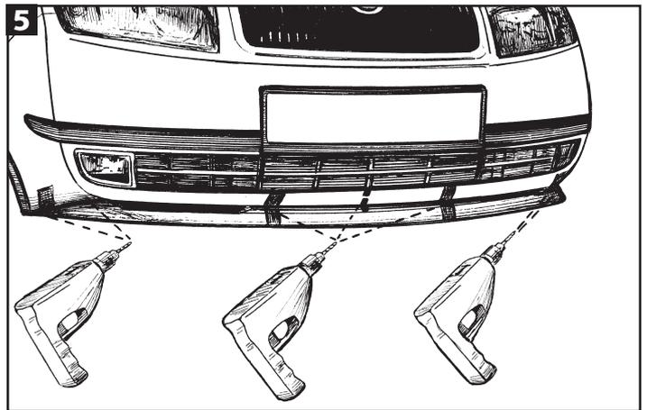
6. Zur Befestigung dienen die mitgelieferten Schrauben mit Distanzscheiben und selbstsichernden Muttern (siehe Schraub-Schema). In Wagenfarbe lackiert, wirkt die Spoiler-Lippe besonders attraktiv. Bitte beachten Sie die Hinweise des Lackherstellers speziell für das Lackieren von Kunststoffteilen an Fahrzeugen. Außerdem empfehlen wir grundsätzlich die Hilfe Ihres Skoda-Partners.
